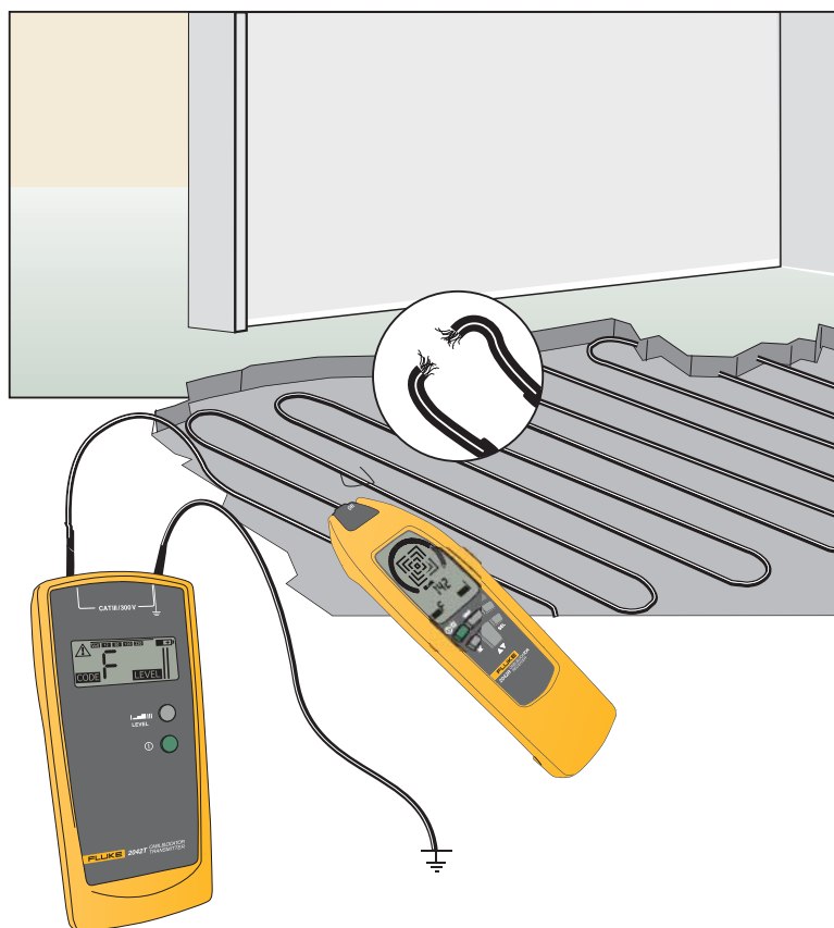
Vyhledávání poruch v elektrickém podlahovém topení
